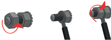
Figure 7. Connexion de l'appareil au dispositif équipotentiel.
