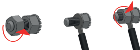
Bild 7. Der Anschluss des Gerätes an die Potentialausgleichsanlage
