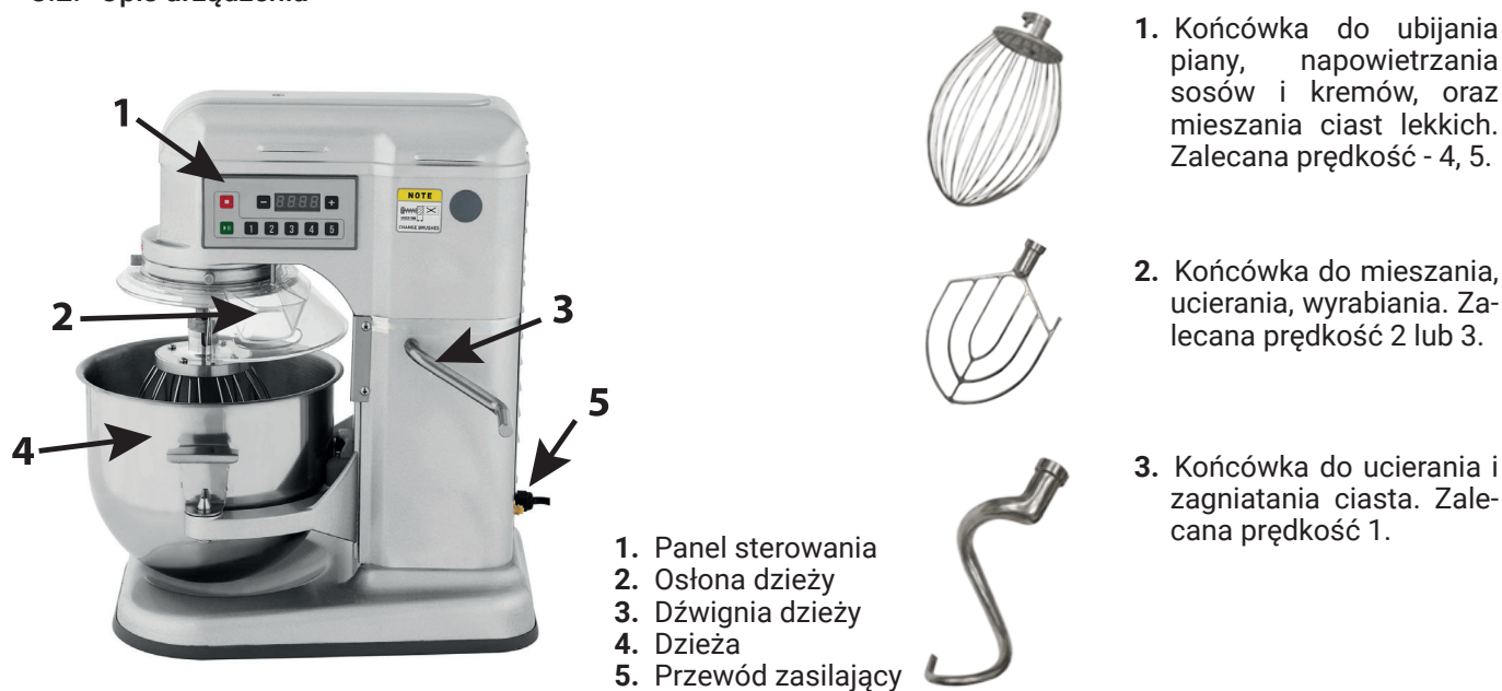
Rysunek 1. Budowa urządzenia
